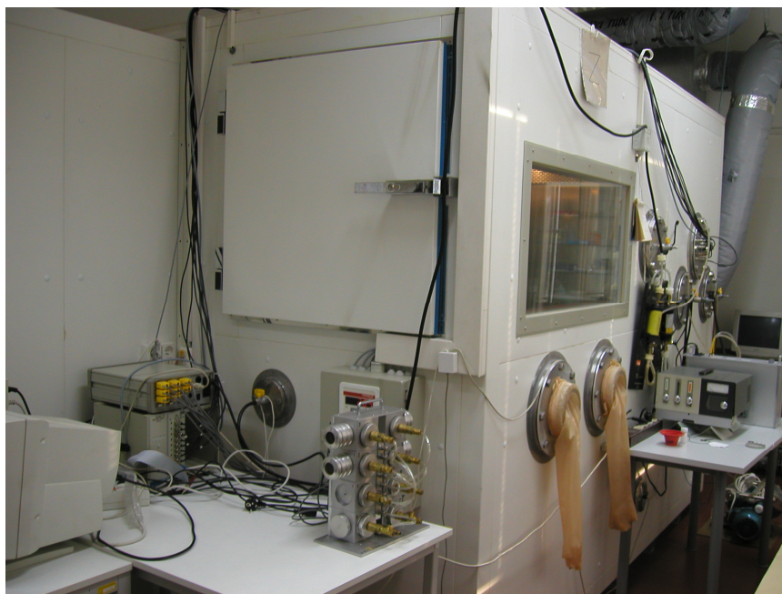
Rys. Radon-4.5.1. Radonowa komora kalibracyjna w Centralnym Laboratorium Ochrony Radiologicznej w Warszawie.
