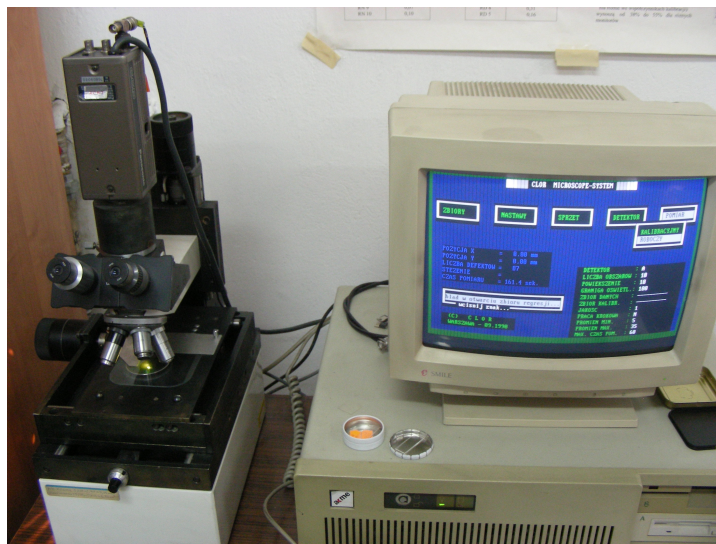
Rys. Radon-4.1.3.2. Układ do zliczania gęstości śladów w detektorach CR-39.
