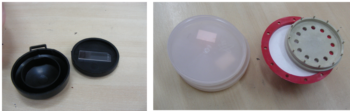
Rys.Radon-4.1.3.1. Przykłady komór dyfuzyjnych z detektorami śladowymi.
