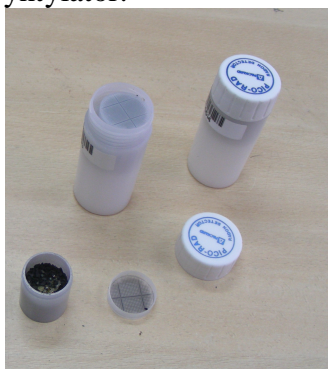
Rys. Radon-4.1.2.1. Elementy systemu PicoRad: licznik ciekłoscyntylacyjny Tri Carb 1900 TR, detektory węglowe i ciekły scyntylator.
