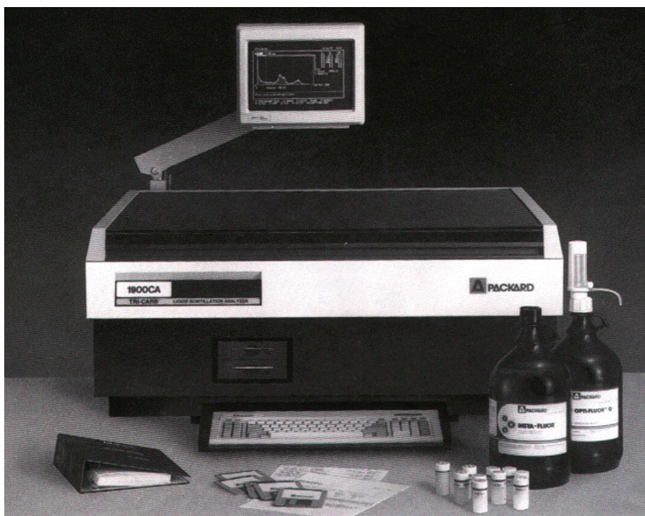
Rys. Radon-4.1.2.1. Elementy systemu PicoRad: licznik ciekłoscyntylacyjny Tri Carb 1900 TR, detektory węglowe i ciekły scyntylator.
