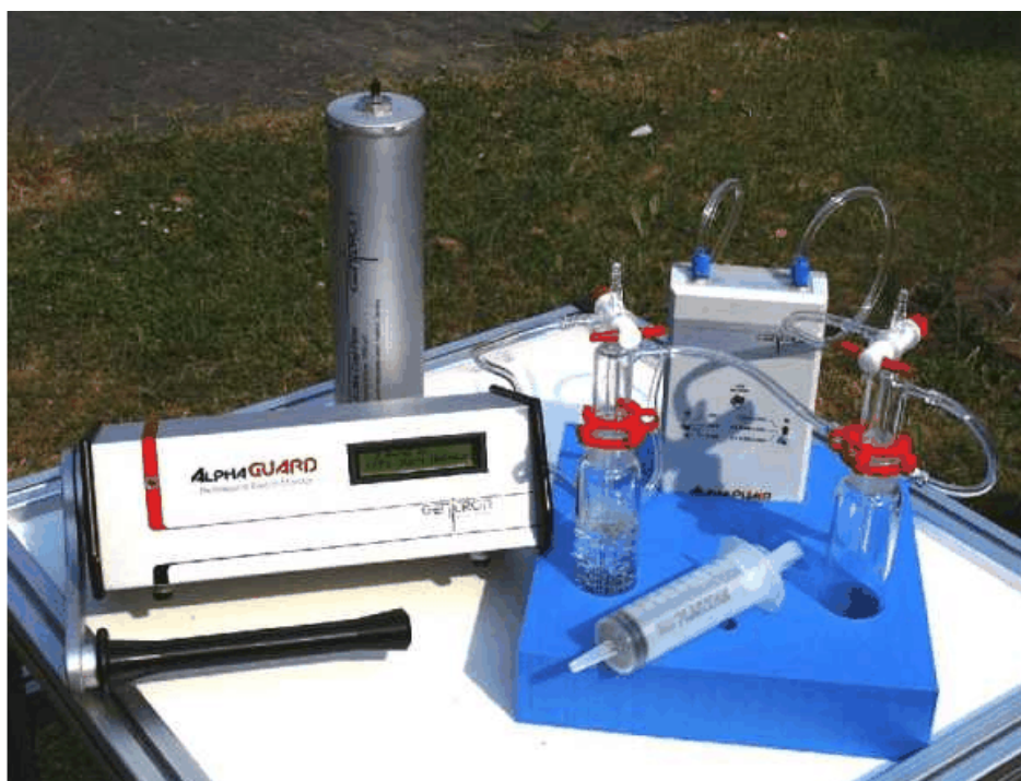
Rys.Radon-4.3.1. Zestaw AquaKIT do pomiaru stężenia radonu w próbce wody za pomocą monitora AlphaGUARD.
