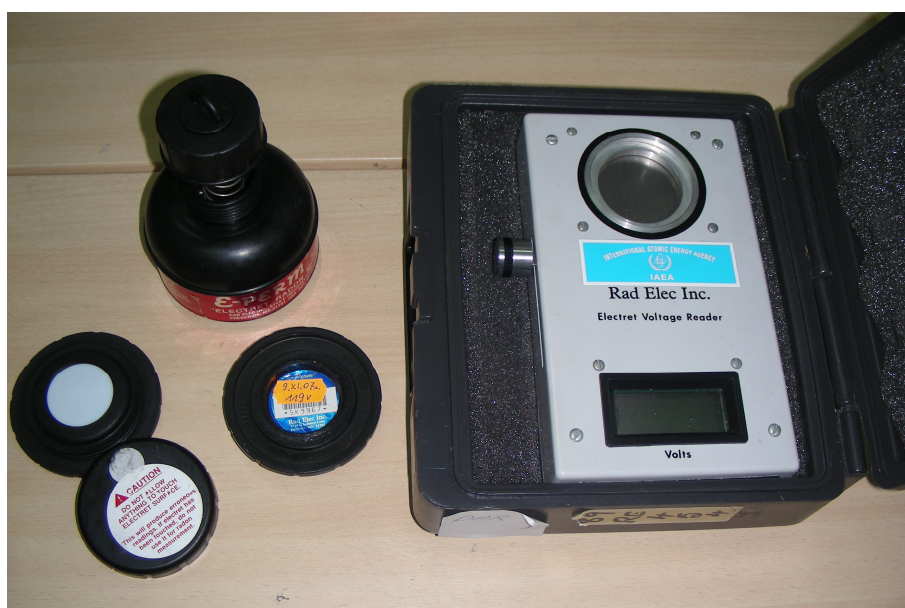
Rys. Radon-4.1.4.1 E-PERM-system: zbliżeniowy czytnik potencjału i komory elektretowe.
