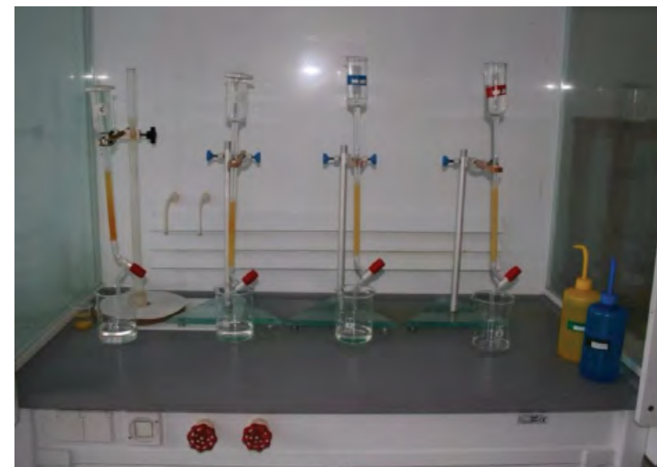
Kolumny jonowymienne do oznaczania izotopów plutonu, uranu, toru, polonu.
