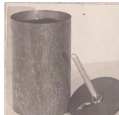
Jedna z komór jonizacyjnych zaprojektowana do pomiaru promieniowania rozproszonego.
