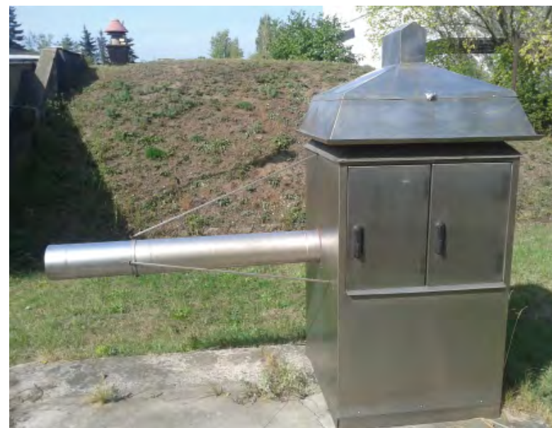
Stacja ASS-500 do poboru aerozoli z przyziemnej warstwy atmosfery – zlokalizowana na terenie CLOR.
