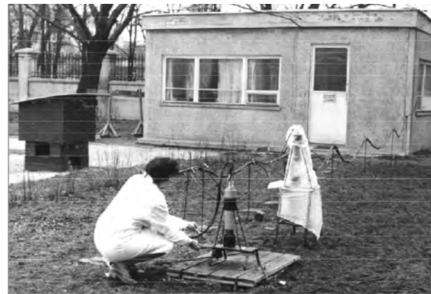
Mini-laboratorium do badań tła promieniowania na terenie filtrów warszawskich.
