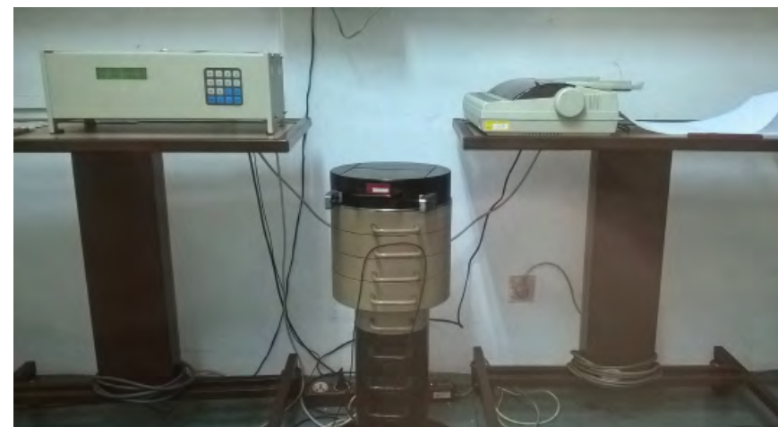
Analizator MAZAR-95, służący do pomiaru promieniotwórczości naturalnej surowców i materiałów budowlanych.
